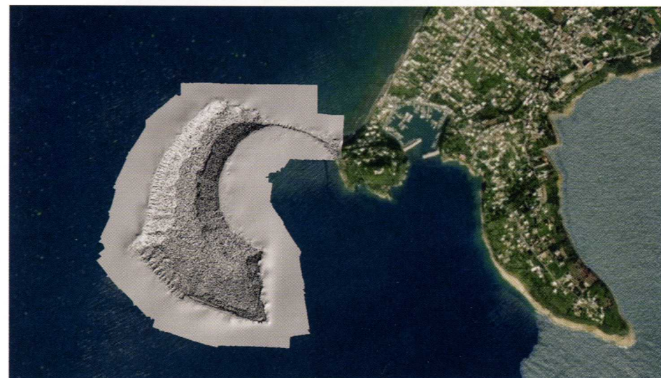
Fig. 6 – Hillshade su modello drone 3D LIDAR generale, ottenuto in ambiente ArcGis Pro
