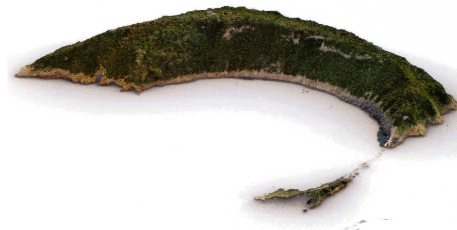
Fig. 3 – Modello 3D generale dell'isolotto di Vivara, in vista Golfo di Genito, ottenuto attraverso post processing dei dati LIDAR da drone DJI Matrice 300
