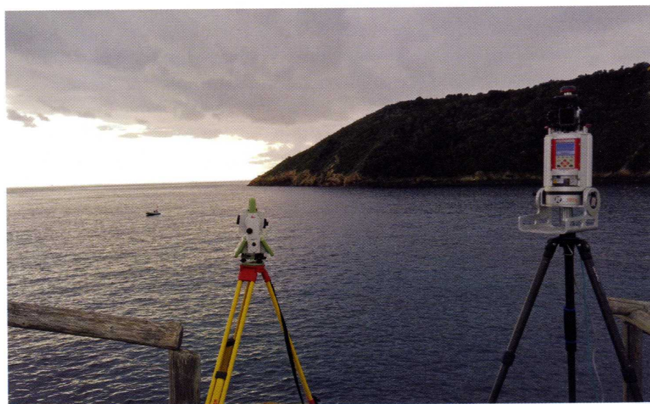
Fig. 1 – Rilievo dei marker terrestri Mediante Riegl vz-400 (strumento sulla destra)
