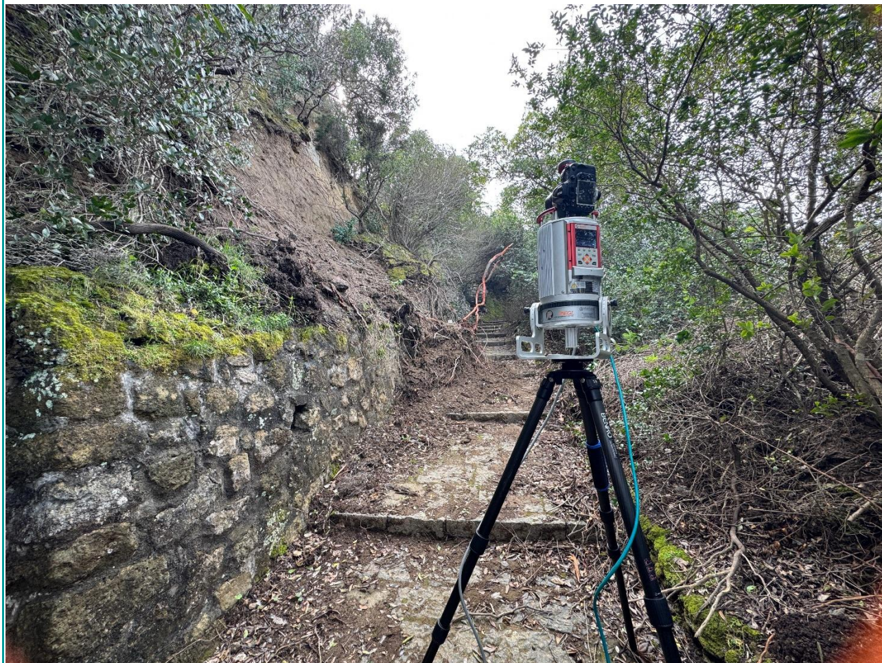
Fig.02 Fasi di acquisizioni mediante scanner Riegl VZ400 – Frana recente
