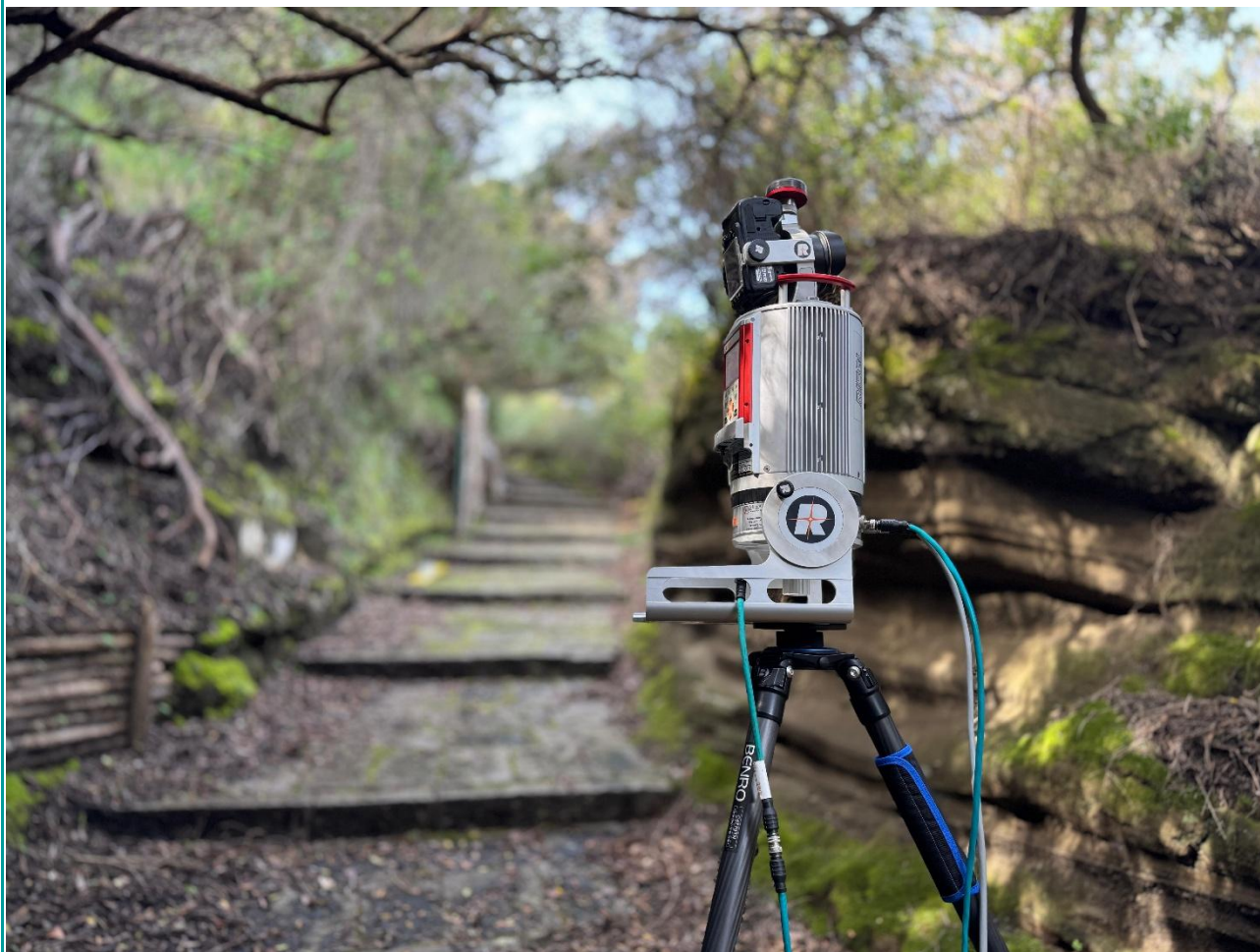
Fig.01 Fasi di acquisizioni mediante scanner Riegl VZ400 – Frana 1
